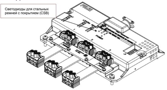
Каждый светодиодный индикатор (СИД) отображает кодовый номер состояния соответствующего стального ремня с покрытием. Однако в целях упрощения индикация состояния конкретная причина состояния «Предупреждение» или «Тревожное состояния» ремня или нескольких стальных ремней с покрытием должна определяться с использованием сервис тула.
