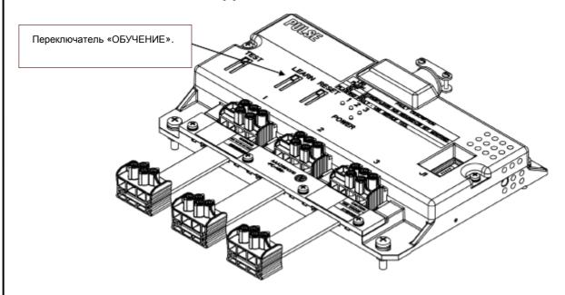
На блоке системы PULSE нажать переключатель «ОБУЧЕНИЕ» три раза в течение пяти секунд для перезагрузки состояния «Предупреждение» и «Тревога».
